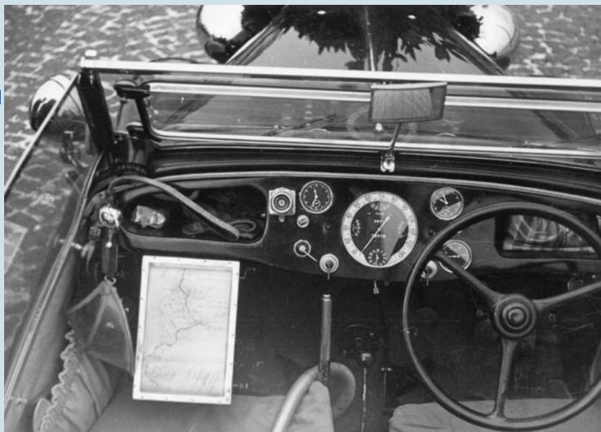
Vůz se stahovací střechou byl vybaven mimo jiné topením, elektrickým vyhříváním části čelního skla, držáky na termosku i mapu a hledáčkem (pátracím světloometem).
