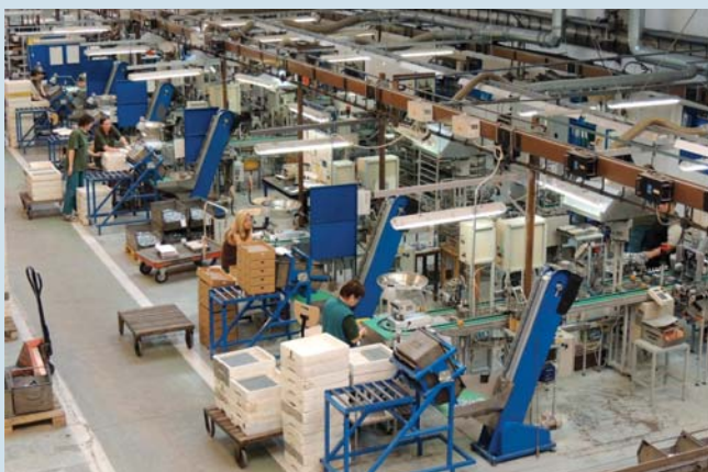
Současné modulární montážní linky pro výrobu zapalovacích svíček.
