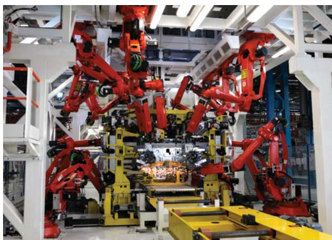
Bodové svařování (spot welding).
