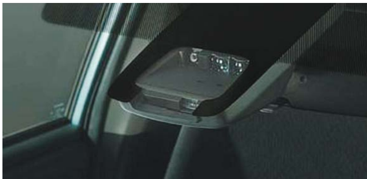
Kamera a laser systému zabraňujícího kolizím jsou umístěné u zpětného zrcátka řidiče.
