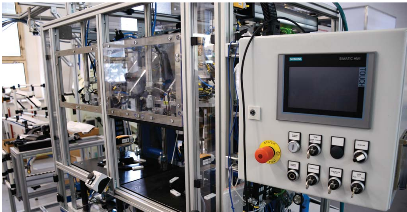
Plně automatický jednoučelový stroj, který ověřuje stoprocentní funkčnost dílce a prověří osazení všemi komponenty, je součástí montážní linky kliky dveří vytvořené v divizi Jednoučelové stroje MOTOR JIKOV Fostron a.s.
