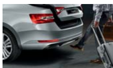
Virtuální pedál - bezdotykové otevření 5. dveří
