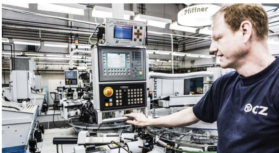
Hromadnou výrobu fitinků v CZ-AUTO zajišťují na vysoce produktivních transferových strojích Hydromat.
