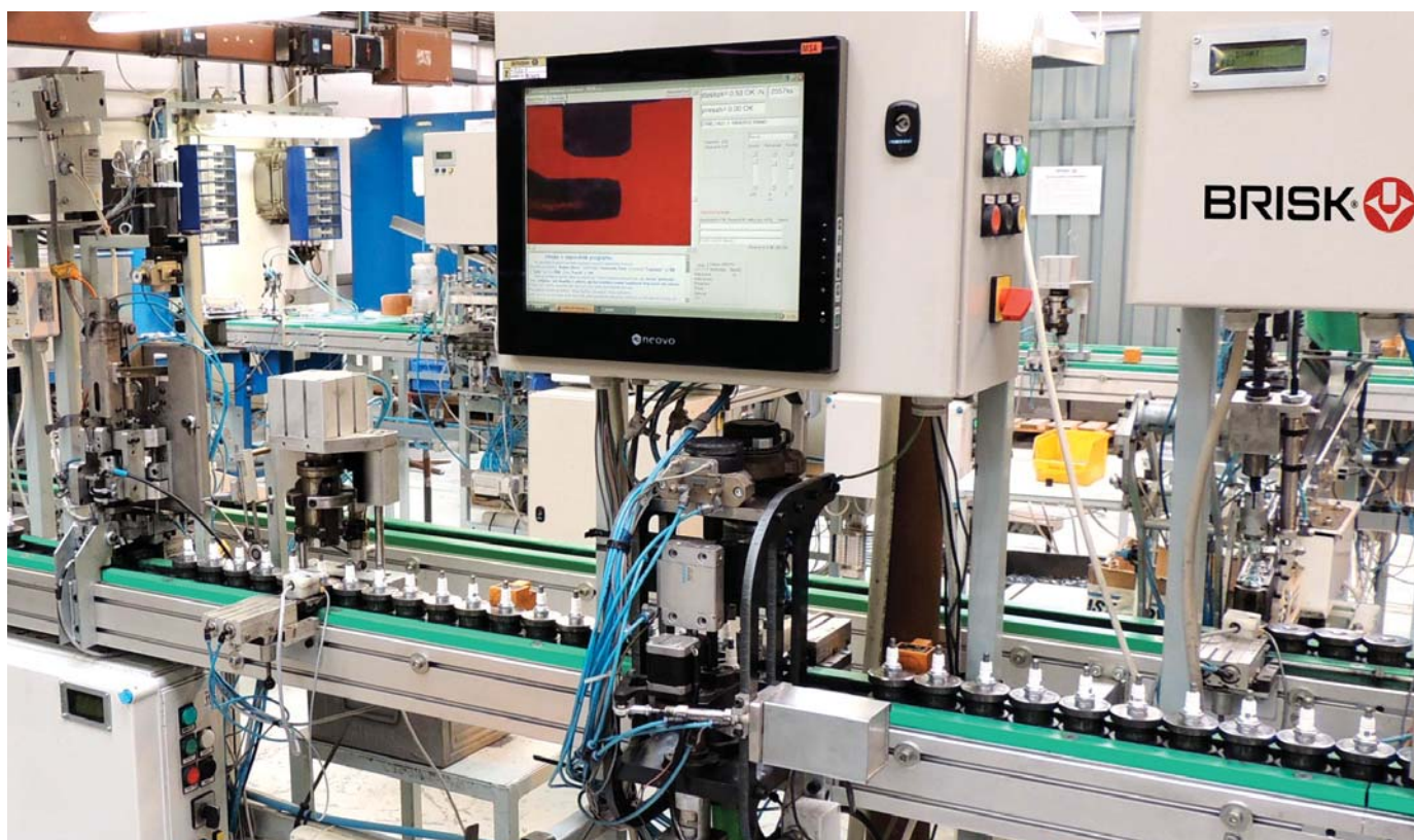
Automatická linka na montáž zapalovacích svíček. Vývoj a konstrukci těchto linek s flexibilními moduly si firma BRISK Tábor realizuje vlastními odborníky.
