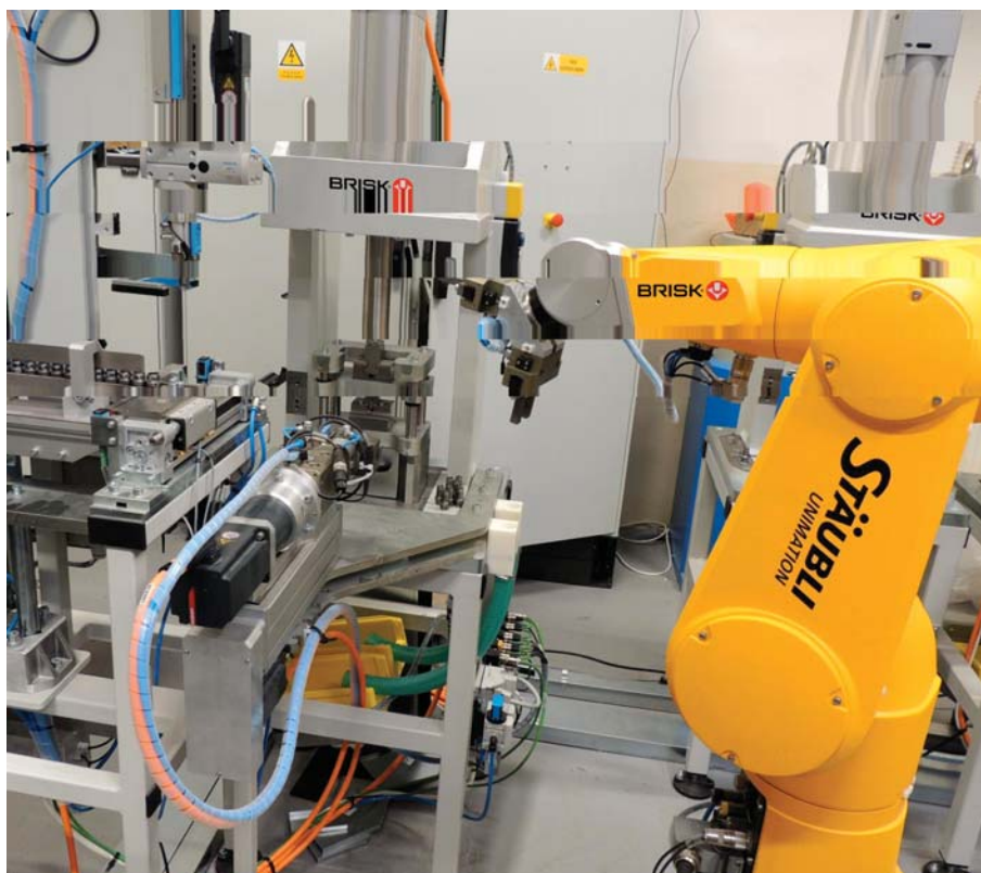
Robořícké pracoviště Davep na úpravu kovového pouzdra se specifickým tvarem vnějších elektrod
