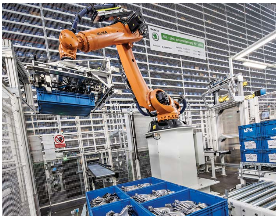
Roboti přepravují díly ze skladu přímo na linku.
