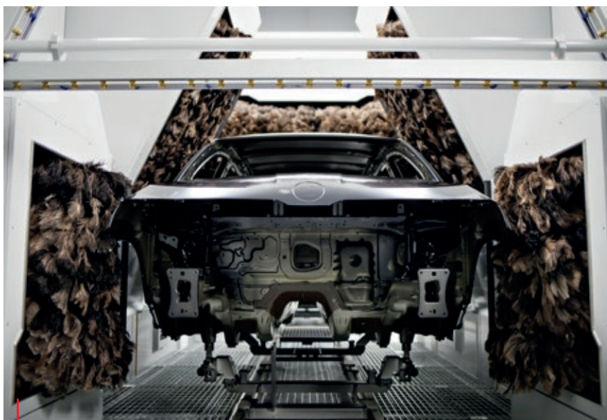
Nejmodernější lakovna disponuje více než šesti desítkami robotů. K dokonalému vyčištění lakovaného povrchu karoserií používá pštrosí péra. Foto: ŠKODA AUTO
