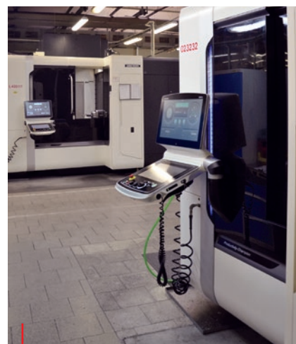
V posledních letech firma výrazně investovala do modernizace. Nejnovější horizontální obráběcí centrum DMG MORI se využívá pro obrábění podávacích čerpadel, mezipřírub a některých typů vstřikovačů. Foto: MOTORPAL
