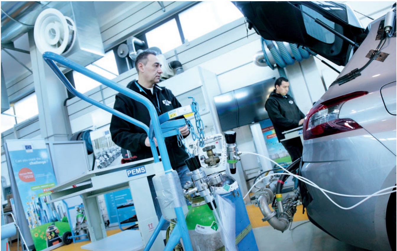
Emisní zkoušky se mají nově provádět v reálných podmínkách s pomocí zařízení PEMS. Na snímku laboratoř Společného výzkumného střediska (JRC) se sídlem v Ispře (Itálie)
