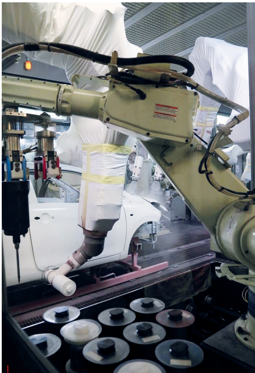
V lakovně už nainstalovali nové roboty pro lakování karoserií vozů.
