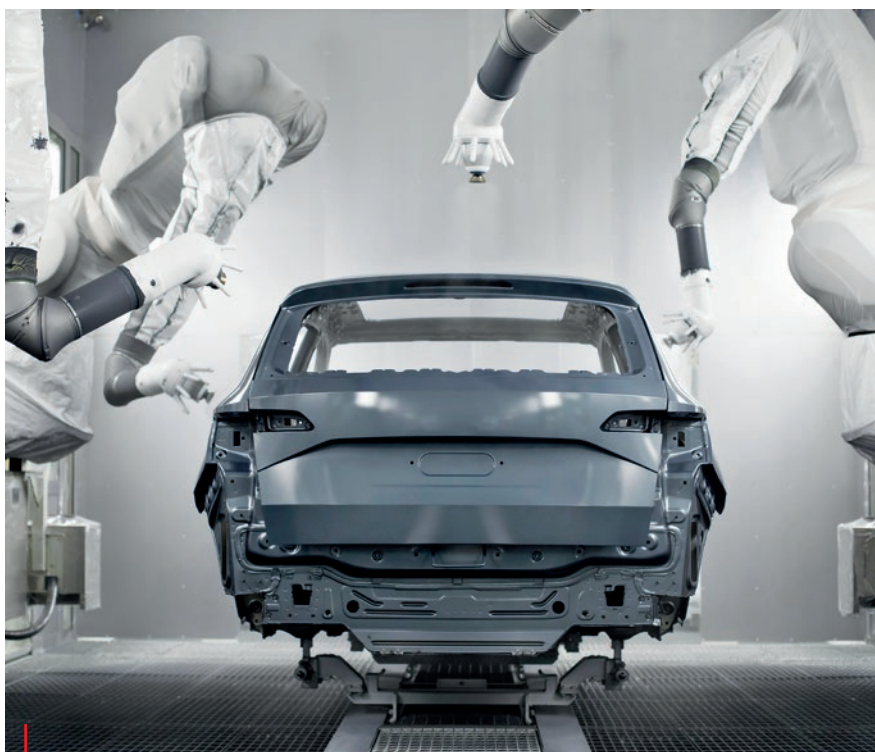
V nové lakovně se o řadu pracovních operací stará 66 robotů.
