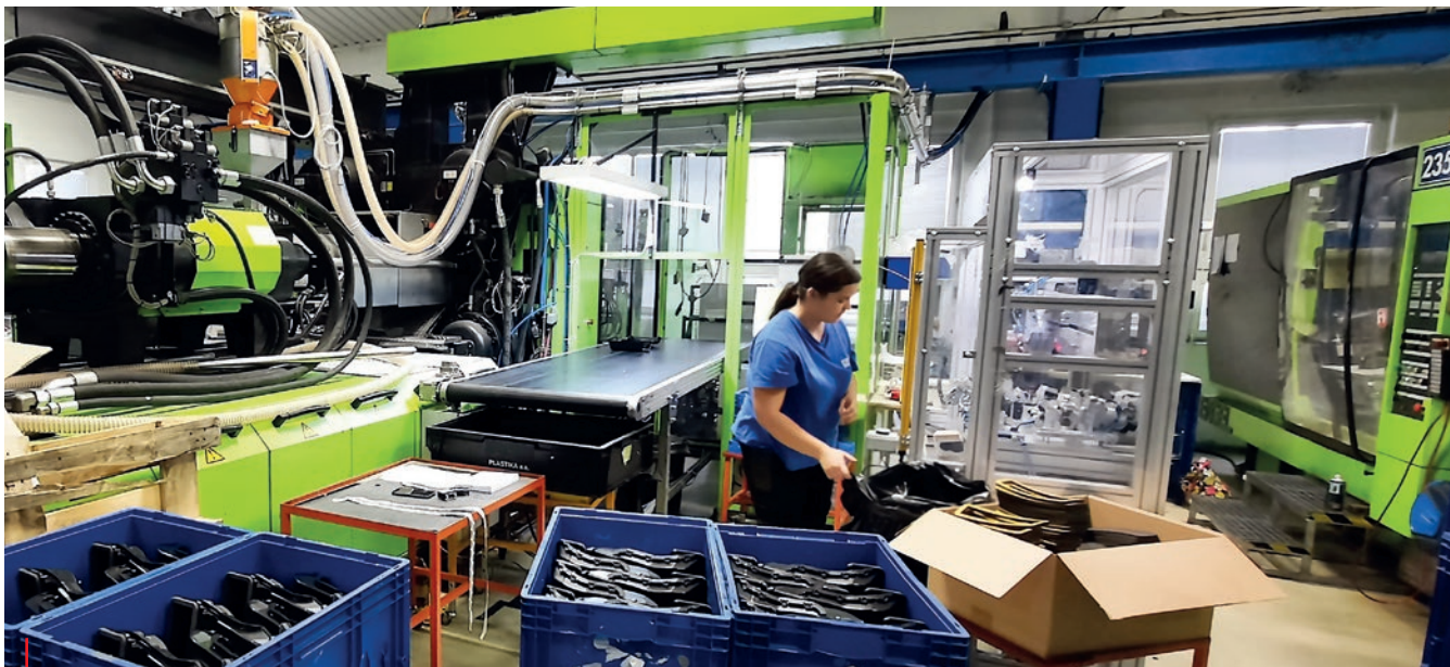
PLASTIKA využívá celé spektrum technologií od lisování přes svařování, galvanické pokovení, lakování, lepení až po montážní práce. Na snímku je pracoviště kontroly u vstříkolisu. Foto: AutoSAP/Libuše Bautzová
