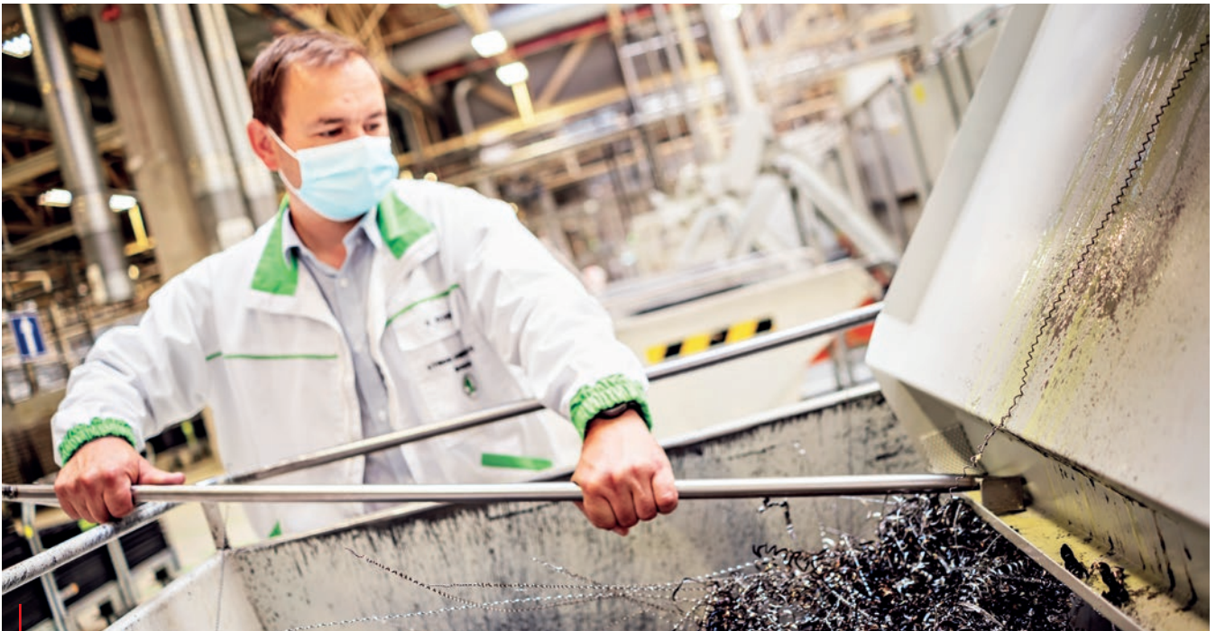
Jedním z úsporných opatření, která zavedli ve vrchlabském závodě ŠKODA AUTO, je úprava dopravníku špon tak, aby se zbytková emulze vracela zpět do stroje bez dalších nákladů. Foto: ŠKODA AUTO
