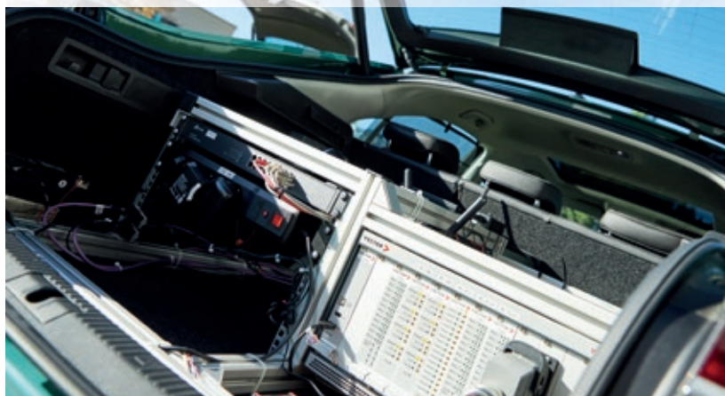
Na obrázku je zachycena implementace 1. generace systému Drive-by-Wire Car Interface do experimentálního vozidla Škoda Superb IV. Spin-off autinno provádí výrobu a distribuci a zajišťuje servis 2. generace tohoto systému. Foto: VŠB-TUO
