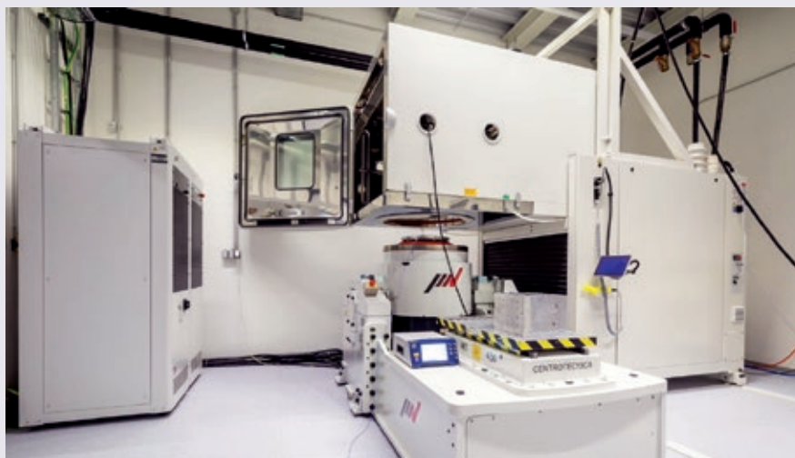
Vibrační testovací stav simulující nárazy, otřesy a kmity vozidla při běžném provozu vozidla dokáže vyvinout maximální přetížení 100G. Foto: Vitesco Technologies
